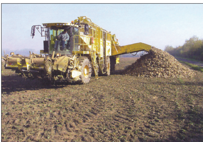
در موقع تخلیه بونکر با حداقل ارتفاع کار کنید تا ضایعات به حداقل برسد
